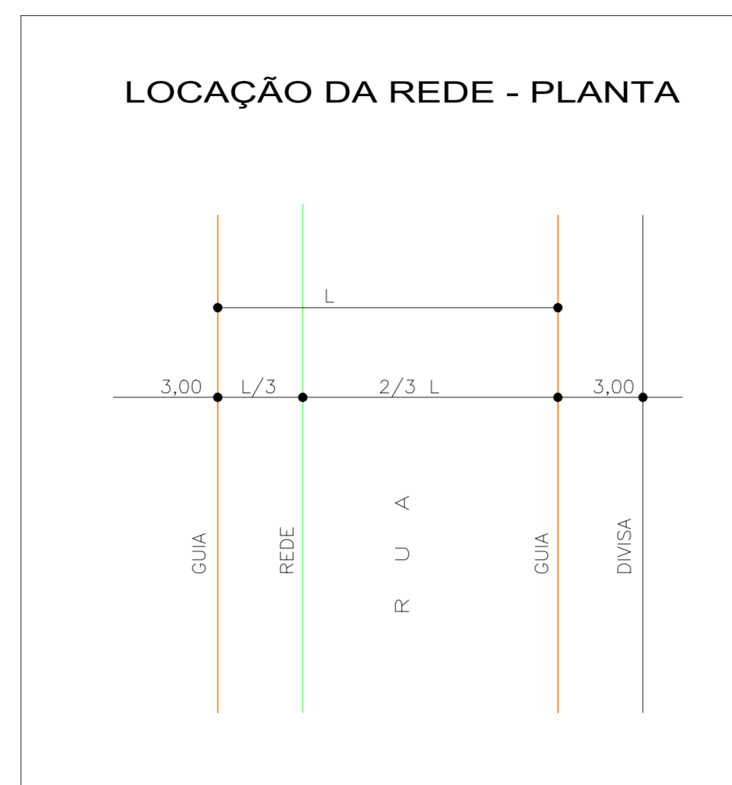
DETALHE DA LOCAÇÃO DA REDE S/ ESCALA
